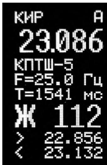
Рисунок 10. Пример страницы характеристик и текущего состояния сигналов АЛСН.
