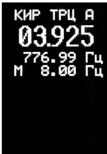
Рисунок 9. Пример страницы детализации параметров обнаруженных ТРЦ сигналов.
