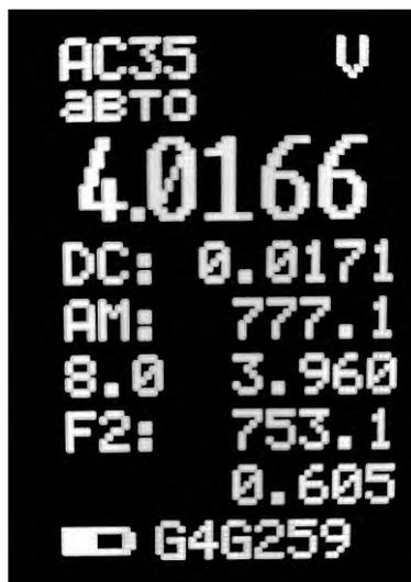
Рисунок 6. Пример вида экрана при измерении АС.
